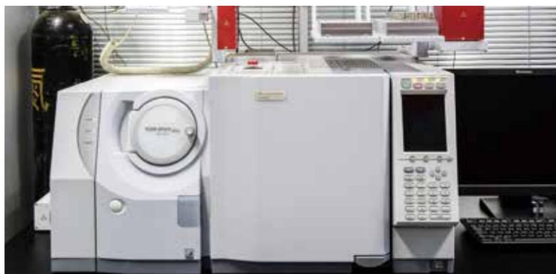
**品牌型号** - SHIMADZU GC-MS QP2010 PLUS
