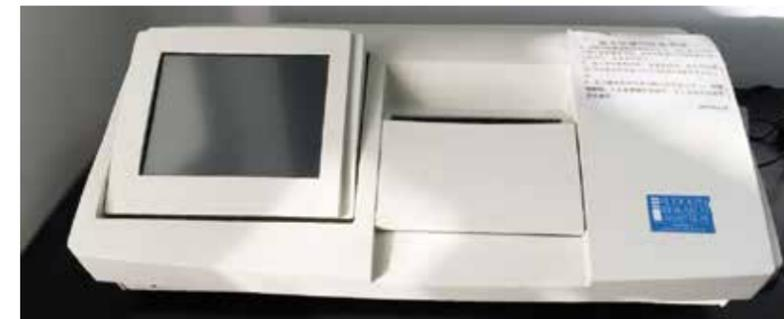
旋光仪通过对样品旋光度的测量，可以分析待测物质的浓度、含量及纯度等；研究蛋白质 / 肽链折叠、蛋白质构象；研究金属络合物、聚合物等的空间构型。
