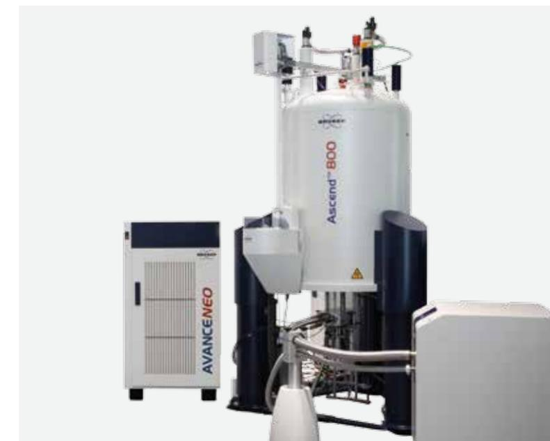
800 MHz 核磁共振谱仪主要用于研究蛋白质、核酸及多糖等各类生物大分子的结构和功能。通过结合核磁共振技术和其它多种实验及计算方法，可以对具有重要生物学功能的生物分子体系进行系统研究，得到生物大分子的溶液结构、动力学性质等信息。此外，还可以开展生物大分子和小分子药物之间相互作用的研究，探索大分子结构与功能之间的关系，为药物研发和设计提供理论指导。此外，800 MHz 核磁共振谱仪还能兼顾其他新的实验技术研究。
