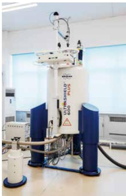
本平台一共有3台600 MHz核磁共振波谱仪，每台仪器配备不同类型的液氮超低温探头，具有不同的功能及用途。其中，600-1为TCI反向三共振探头， $^1\text{H}$ 的灵敏度高，能快速、高效地进行 $^1\text{H}$ 、COSY、NOESY、HSQC、HMBC等一维及二维实验，是天然产物及合成化合物结构鉴定强有力的工具；600-2为BBFO宽带探头，能对 $^{31}\text{P}$ 、 $^{19}\text{F}$ 、 $^{29}\text{Si}$ 、 $^{11}\text{B}$ 等杂核进行检测，可准确、快速地给出含杂原子的药物分子的精细结构信息，还可用于探索生物大分子的动力学性质；600-3为DCH正向探头， $^{13}\text{C}$ 的检测
