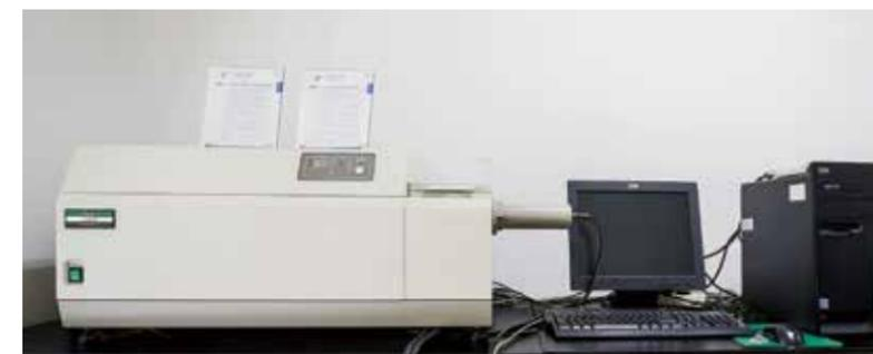
圆二色光谱仪用于表征天然产物、生物物质、手性化合物的旋光特性；研究蛋白质 / 肽链折叠、蛋白质构象、DNA/RNA 相互作用；测量酶动力学、光学活性物质纯度；药物定量分析；研究天然有机化学与立体有机化学、物理化学、生物化学与宏观大分子、金属络合物、聚合物化学、热变性和化学变性。
