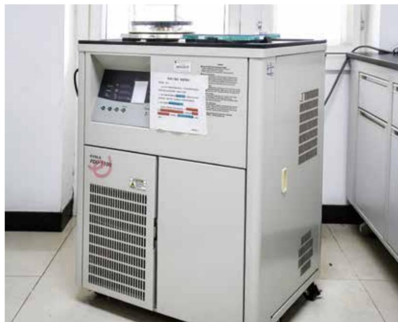
冻干机通过低温高真空条件下将样品中溶解升华实现样品的浓缩以及去溶剂化。由于一些物质在加热条件下易变质，无法采用加热的方法进行浓缩。而冻干机在  $-40^{\circ}\text{C}$  条件下工作，可以避免加热对样品造成的伤害，特别适用于纳米材料及蛋白质样品的制备。
