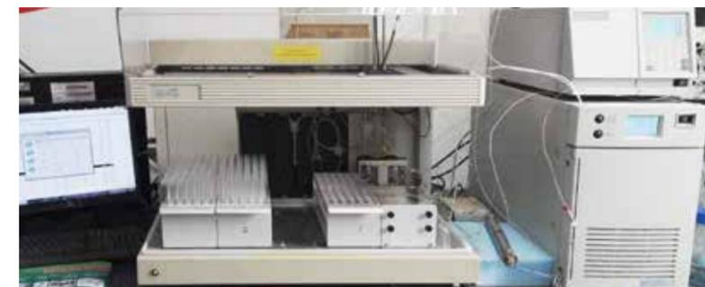
平台有制备级色谱 3 台，其中一台配备了自动收集装置。该仪器需要与制备级色谱柱配合使用，一次可以分离 mg 级样品，可以显著提高样品分析速度。同时该仪器可以配合常规分析液相使用，将常规液相的方法调整后使用在制备液相上，减少条件优化所需时间。
