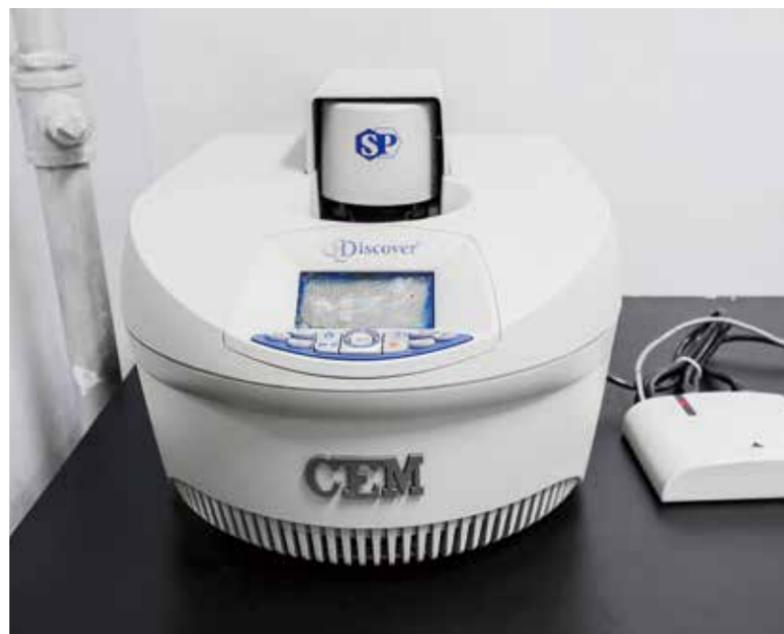
微波合成仪采用环形聚焦单模微波合成系统，比传统加热方式速度快 10-1000 倍，比传统方法产率提高 50%-100%，适用于药物前躯体的合成。该仪器配备有不同容积的反应管，适用于不同量级的合成。
