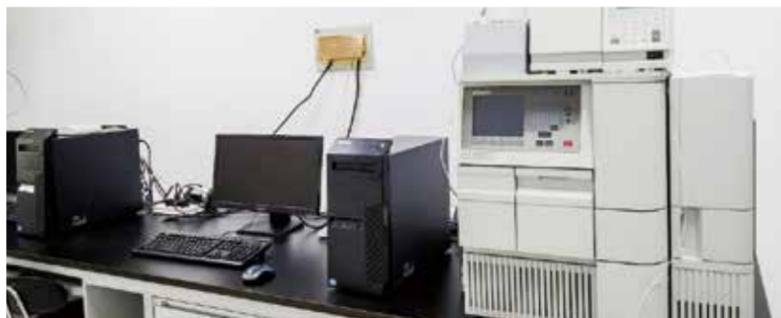
分析型高效液相色谱（5 台），可以用于样品的成分分析以及含量测定。同时也可以满足少量样品制备的需求。仪器配备了二极管阵列检测器、紫外可见检测器，蒸发光散射检测器，荧光检测器。其中一台加装了正相脱气包，可以使用正相色谱模式分析手性样品。
