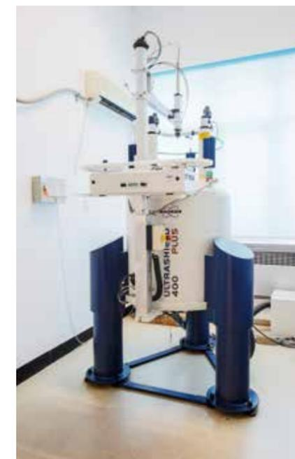
400 MHz核磁共振波谱仪主要用于确认含量比较高、结构简单的天然产物和有机合成分子的结构，以及对已知或未知的常规化合物进行初步筛选。本平台一共有400 MHz核磁共振波谱仪5台，包括4台Bruker核磁共振波谱仪，1台中科牛津核磁共振波谱仪。其中，4台仪器配备有宽带探头，能检测多种核素；2台仪器配备有变温单元，变温范围为 $[-150^\circ\text{C}, 150^\circ\text{C}]$ ，可以开展变温实验，研究分子的动力学性质和分子构象。所有仪器实行全年无休、全天24小时开放，供经过培训且通过考核
